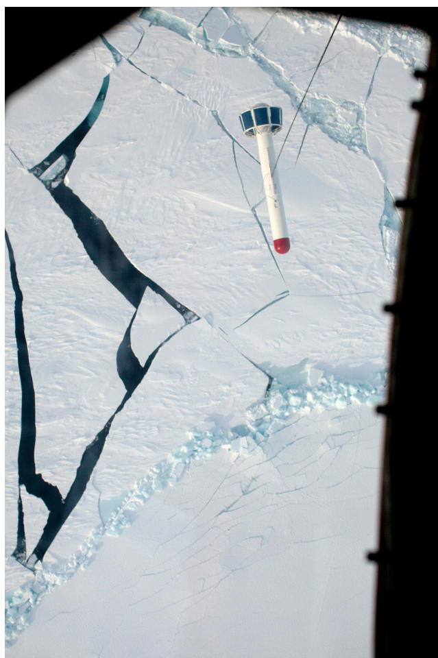
Bedre teknologi, målemetoder og tilgang til data, for eksempel gjennom bruk av måleinstrumenter som "EM Bird" som henger under fly, gir styrket tiltro til vurderingene av endringer og trender i havisen i Arktis. Foto: Nick Cobbing
