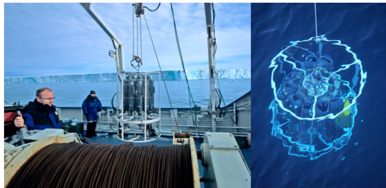
For å finne ut hvor varmt og salt havet er, bruker forskerne et instrument som heter CTD. CTD er en forkortelse for Conductivity, Temperature, Depth. Den måler vannets saltholdighet og temperatur i forskjellige dybder på sin ferd ned gjennom havdypet. Slik kan forskerne finne ut hvordan havstrømmene beveger seg i forskjellige nivåer i vannsøyla. Foto: Tor Ivan Karlsen, NP (CTD settes ut) og Sebastian Gerland, NP (CTD i vannet).
