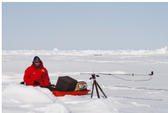
Figur 18. Albedomålinger i Framstredet i mai 2008 som en del av NFR prosjektet «IAOOS Norway» innenfor rammen av det internasjonale polaråret 2007–2008. Til høyre ser man sensor foreoptics der solstråling blir fanget opp og sendt gjennom en fiberkabel til et spektrometer (på sleden i midten). Spektral informasjon om solstråling blir lagret på en tilkoblet datamaskin. Sensoren snus deretter nedover, og måling blir gjort. Dette blir gjort gjentatte ganger (Foto: M Nicolaus, Norsk Polarinstitutt).
