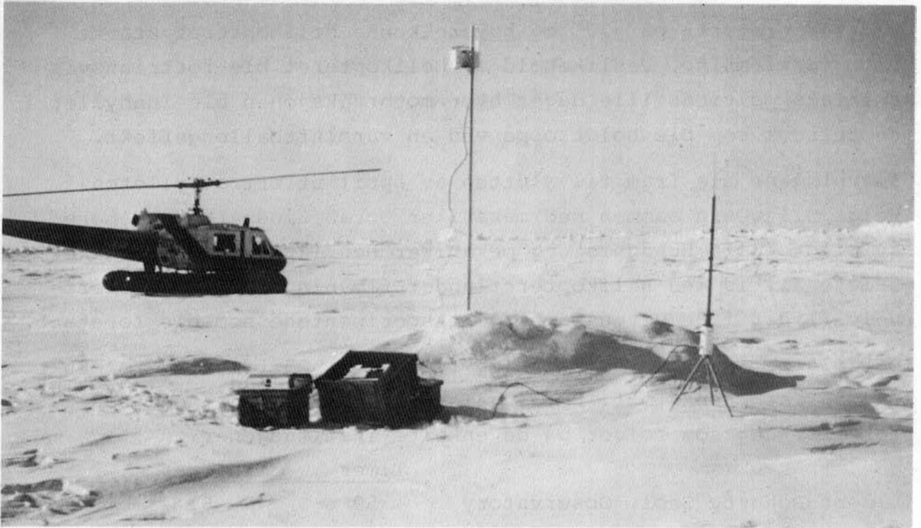
Fig. 25. Motorola navigasjonstransponder montert på mast ca. 15 km fra leiren. Lokalteten ble posisjonert av en Magnavox MX-1502 satelittmottaker (største boks i forgrunnen). Satelittantennen sees til høyre.
