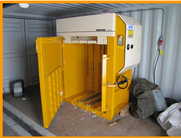
Her ser vi bilde fra "presserommet", der plast og papp blir presset og bunnet i en hydraulisk presse.
