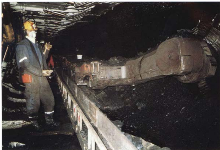
Fig. 102. Moderne gruvemaskin i ferd med å ta ut kull i Sveagruva. Lagene her er betydelig tykkere og arbeidsforholdene derfor på mange måter enklere enn i gruvene ved Longyearbyen, hvor lagene i stor utsrekning er under 1 m tykke, og arbeidet ofte måtte foregå i liggende eller knelende stilling. (S.H.)
