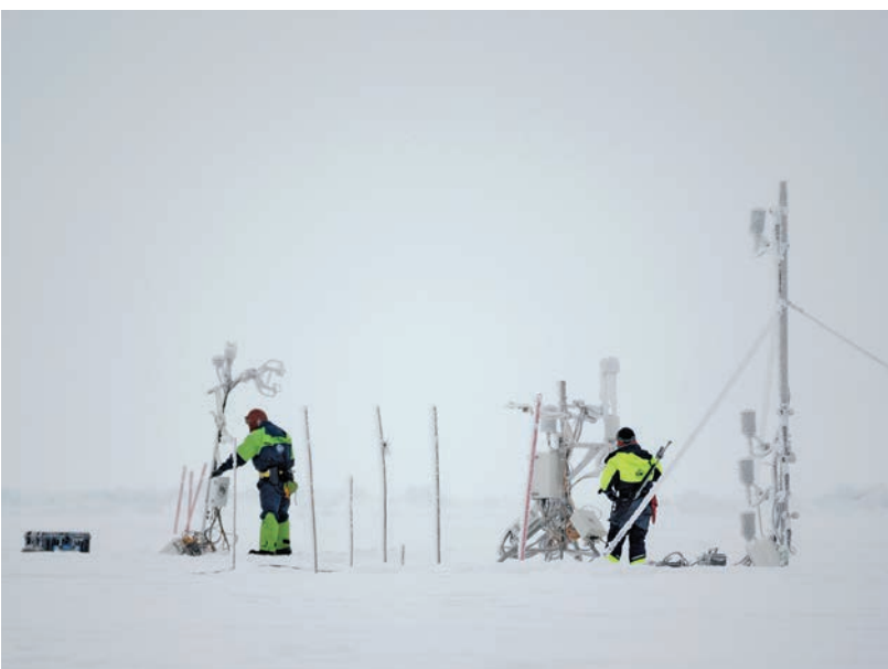
N-ICE forskning. Vi lå i alt 111 dager fast i isen med de fleste måleinstrumenter installert. På bilde sees en 10 meter høy værmast. / We spent a total of 111 days moored to the ice with most of the instruments up and running. This image shows a 10-metre weather mast. Foto/Photo: Nick Cobbing, National Geographic
