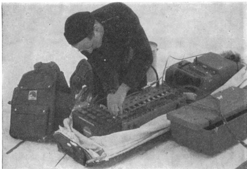
Fig. 7. Et 12-kanalers refraksjonsinstrument montert på en liten slede. Fra venstre: ryggsekk med reservedeler m.m., en bilakkumulator som leverer strømmen til hele anlegget, forsterkerenhet, registreringsenhet. Kassen til høyre er emballasje.
