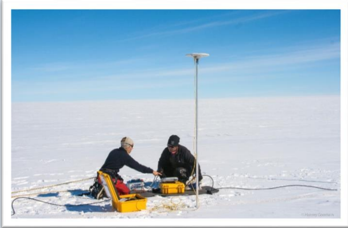
Foto: Katrin och Bhanu installerar en ApRES radar som kan mäta smältningen under den flytande shelfisen.
