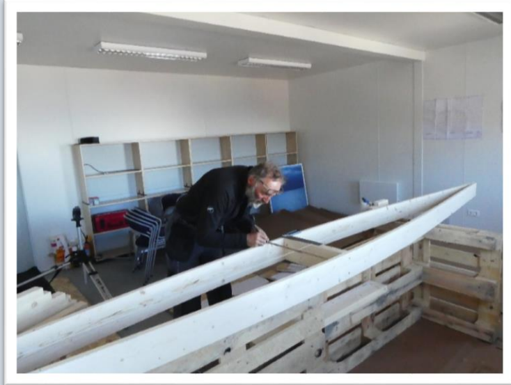
Først må jiggen lages
