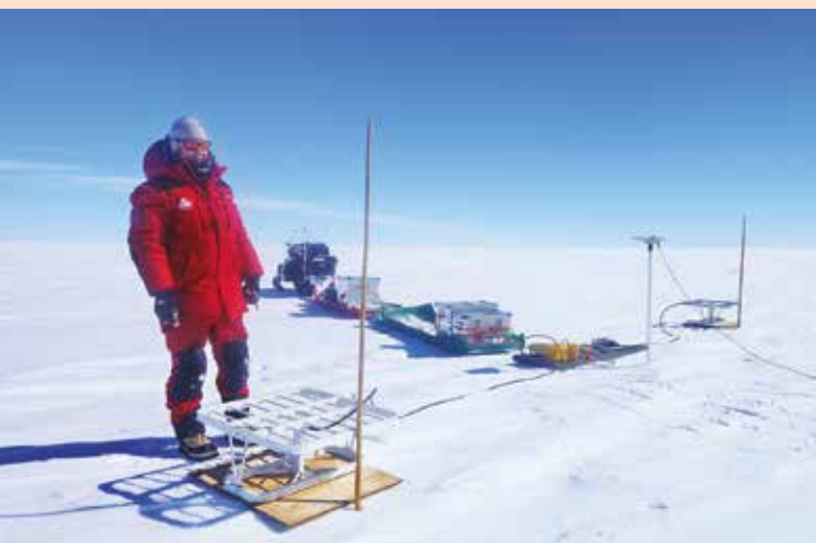
Postdoktor Katrin Lindbäck set opp ein geodetisk GPS og to radarantennar for å måla isbremfart, tjukkeleik og marin smelting ved Nivlisen i Antarktis. / Postdoc Katrin Lindbäck is setting up a geodetic GPS and two radar antennas to measure ice-shelf velocity, thickness and basal melting at Nivlisen in Antarctica. Foto/Photo: Geir Moholdt, NP/NPI
