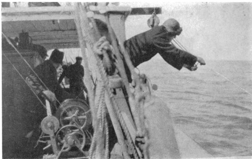
Fig. 9. En vannhenter til settes på.
