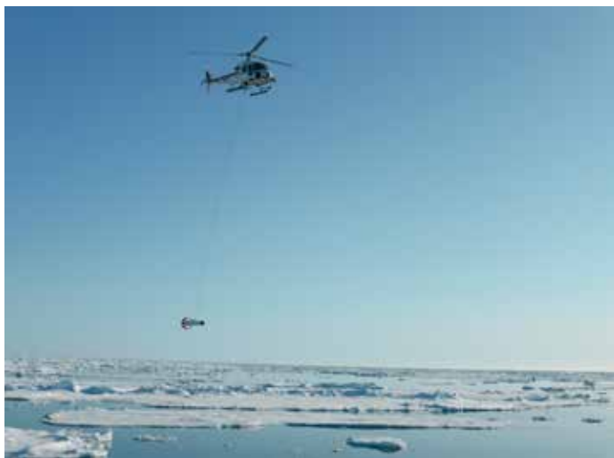
HAVISMÅLING/SEA ICE MEASUREMENT EM-bird brukes til å måle havistykkelse og henger under helikopteret når målinger tas./ The EM-bird, which is used to measure the thickness of sea ice, hangs below the helicopter when measurements are taken. Foto/Photo: Sebastian Gerland, NP/NPI
