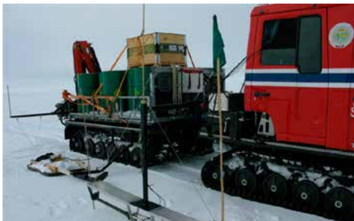
RADARMÅLINGER/RADAR MEASUREMENTS 1) Radarantennen monteret på siden av ekspedisjonens kjøretøy; 2) Inne i kjøretøyet overvåker forskerne Anna Sinisalo og Kirsty Langley innhenting av radardata./ 1) Radar antennas mounted on the sides of the expedition vehicles; 2) Inside the vehicle, researchers Anna Sinisalo and Kirsty Langley monitor radar data acquisition. Foto/Photo: Helgard Anshütz, NP/NPI
