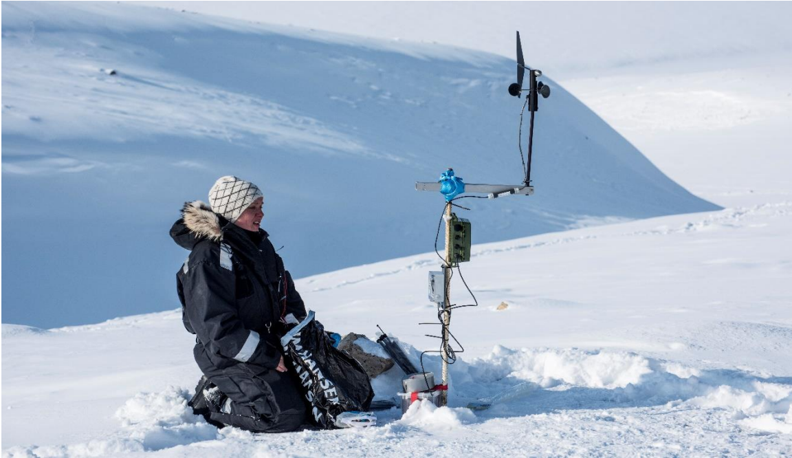
Bildet viser montering av lyttestasjoner i De Geerdalen, Svalbard, som skal ta opp rypesteggens spill for å hevde territoriet. Dette er en videreutvikling av metodikken vi benytter for å beregne tetthet av svalbardrype som er en del av overvåking av denne arten i COAT (og MOSJ). Foto: Siri B. Uldal/Norsk Polarinstitutt.
