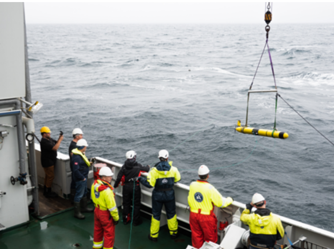
HAVROBOT Fjernstyrte undervannsfarkoster, glidere, gjør hav tilgjengelig for forskning. De måler saltholdighet, temperatur og tetthet, og kan dykke flere hundre meter. På bildet settes en glider ut i Framstredet. Foto: Trine Lise Sviggum Helgerud / Norsk Polarinstitutt
