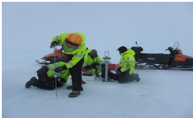
Analyse av isstyrke og prøvetakning på Troll Airfield. Foto: Norsk Polarinstitutt.
