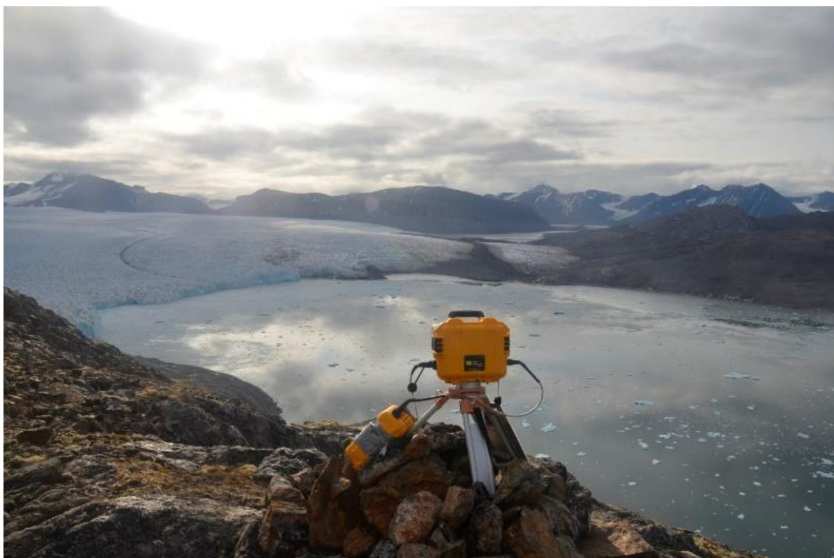
Kamera som tar bilde av fronten av Kongsbreens i Kongsfjorden på Svalbard og registrerer frontposisjoner og kalvinger. Foto: Jean-Charles Gallet, Norsk Polarinstitutt
