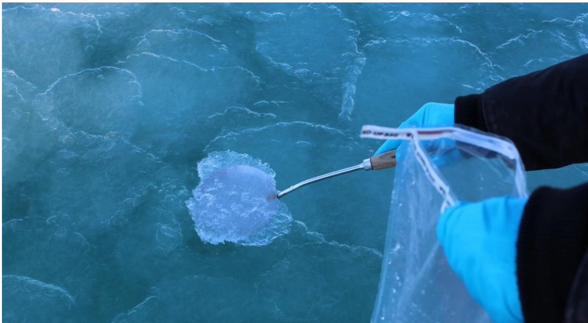
Prøvetaking av tynn havis i Kongsfjorden, Svalbard, i april 2021 under overvåkings- og forskningsarbeid der havisen i fjorden undersøkes. Isbitene er små, rundt 10-20 cm i diameter, men har allerede et preg av såkalt tallerken- eller pannekakeis. Foto: Sebastian Gerland, Norsk Polarinstitutt
