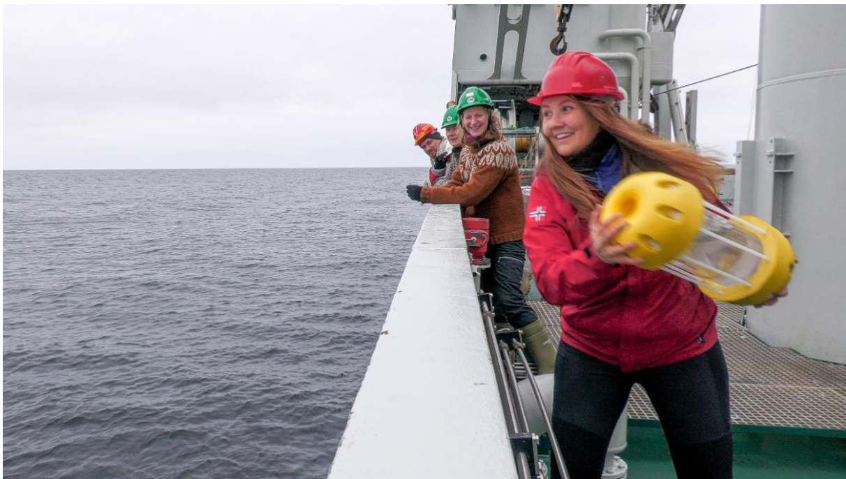
En forskningskapsel som måler reiseveier for marint søppel og plast kastes i havet vest for Svalbard under NPs plasttokt sommeren 2021. Foto: Trine Lise Sviggum Helgerud, Norsk Polarinstitutt
