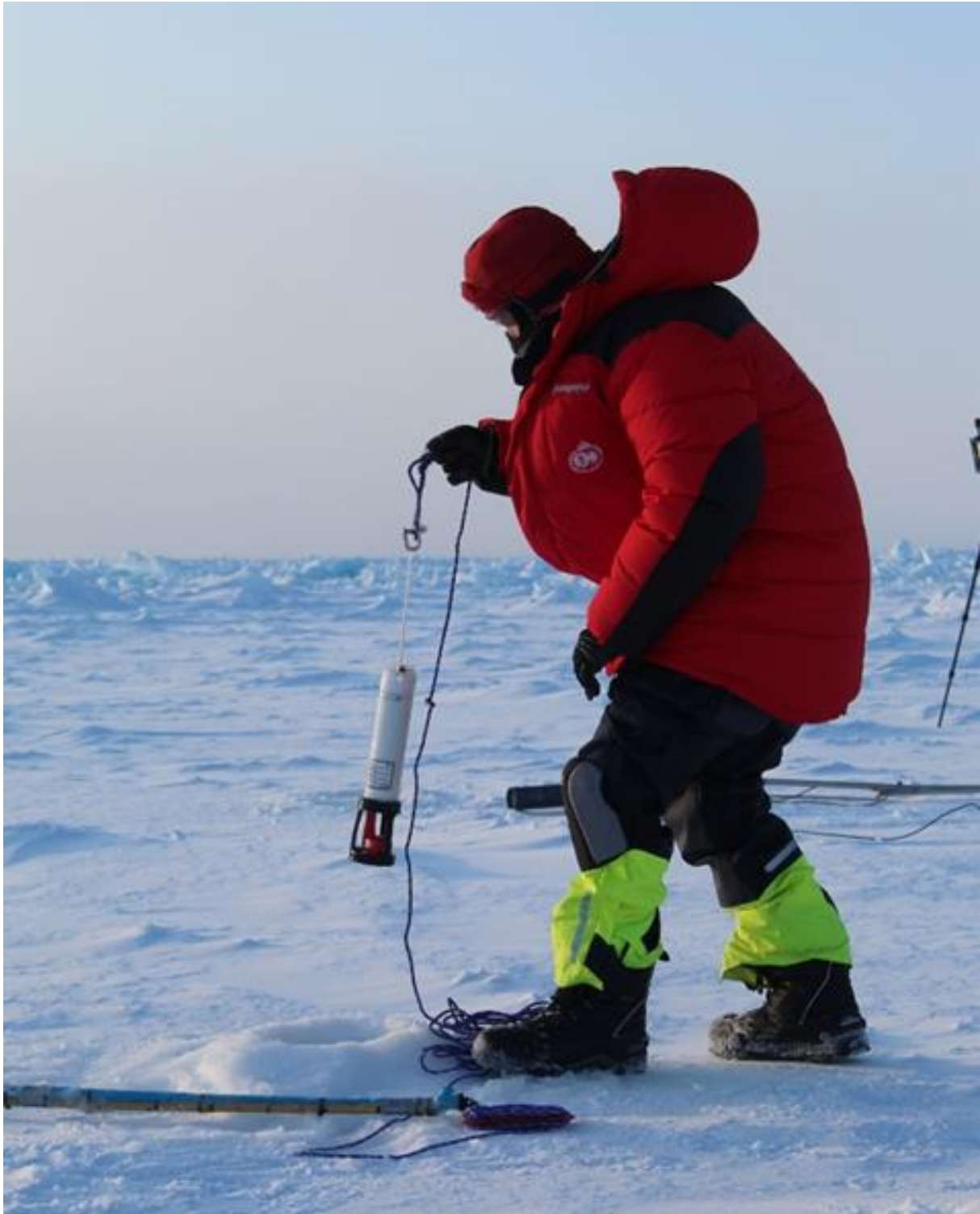
Et borehull i havisen brukes for å slippe ned et instrument til å måle temperatur og saltholdighet i vannet under isen, her gjort nordøst for Svalbard i mars 2021, under Arven etter Nansen Q1 sesongtokt med FF Kronprins Haakon. Foto: Sebastian Gerland, Norsk Polarinstitutt.
